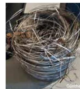
„Besäumen“, sprich: durch Beschneiden entfernt. Man verfährt dabei möglichst materialsparend, damit es dem schrottgierigen Mops nicht zu wohl wird. Denn der besteht aus den langen, feinen Metallschnüren, die beim Schnittvorgang anfallen und anschließend aufgewickelt werden – der Rollmops lässt grüßen.
