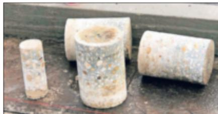
Die bei den Vorbohrungen herausgeholtten Zylinder haben eine Höhe von 30 Zentimeter. Fotos: -gpm.
