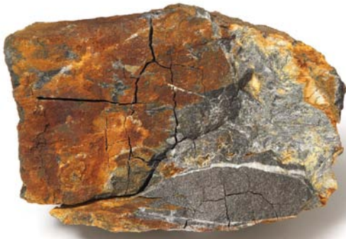
Antimonglanz (Stibnit, Sb_2S_3 ) in quarzitischer Grauwacke, Namurium, Grube Passauf, Bestwig-Nuttlar
