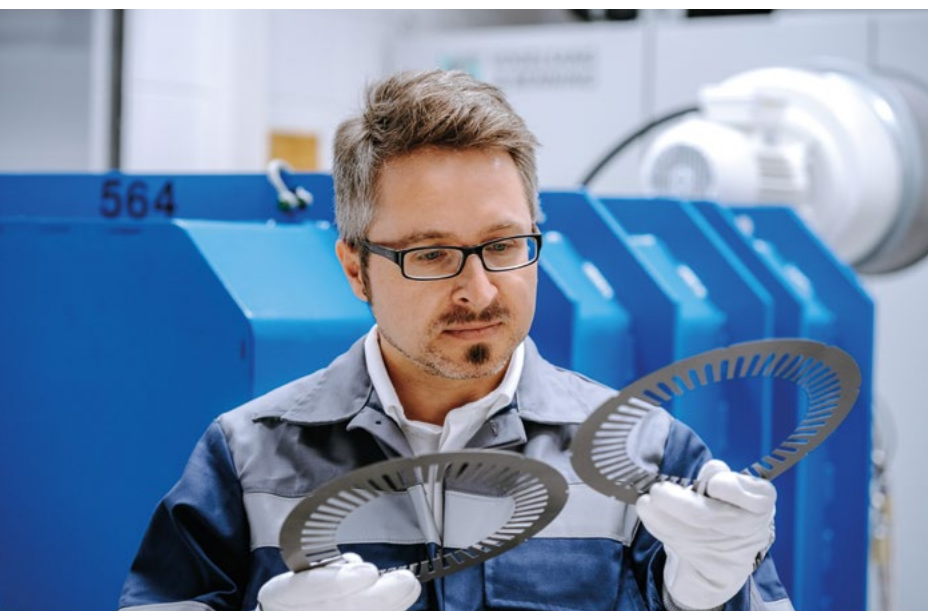
David Pieronek, Produktmanager NO-Elektroband, macht sich ein Bild von den besonders dünnen Elektrobandgüten vom Typ NO25.
