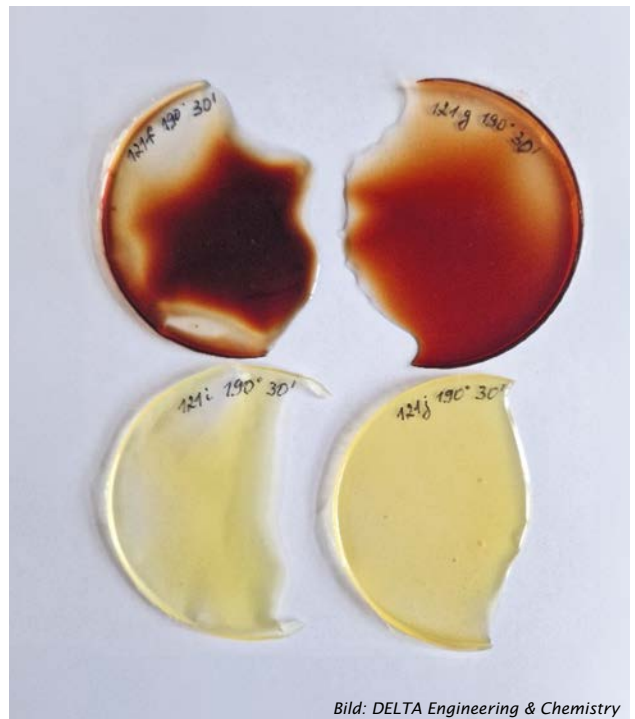
Reihe oben: unpigmentierte Plastisole bei reduzierter konventioneller Stabilisierung (190 °C, 30 Minuten); Reihe unten: unpigmentierte Plastisole ohne Stabilisierung (190 °C, 30 Minuten), erzielt durch alternative Formulierung
