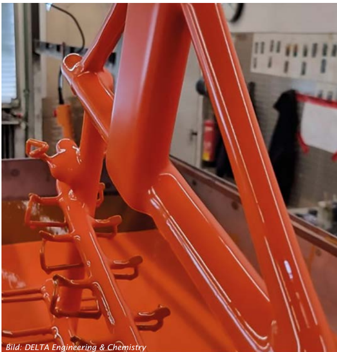
Tauch-Zieh-Prozess bei der Gestellbeschichtung
