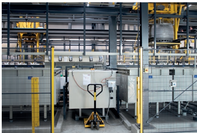
Das Lesegerät mit Antenne am Gate erfasst die eingefahrene Wanne und gibt die Information an die Software weiter.
