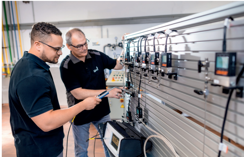
ABBILDUNG 17: TESTSTAND ZUR LECKRATENBESTIMMUNG, QUELLE: DIRK BANNERT, 2022
