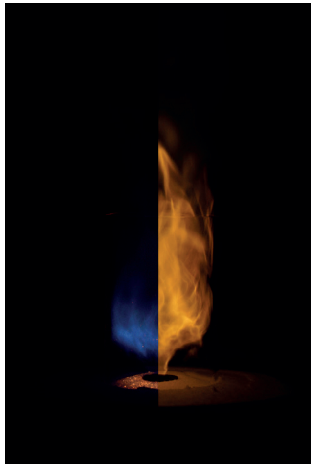
ABBILDUNG 25: FLAMMENBILDER, LINKS: METHAN-LUFT-VERBRENNUNG, RECHTS: AMMONIAK-LUFT-VERBRENNUNG
