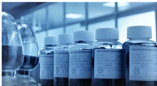
SuperC hat ein Verfahren zur Herstellung von Graphen in wenigen Schichten (Few-layer Graphene FLG) entwickelt. Damit lassen sich Pasten für Elektroden in Lithium-Ionen-Batterien herstellen.
