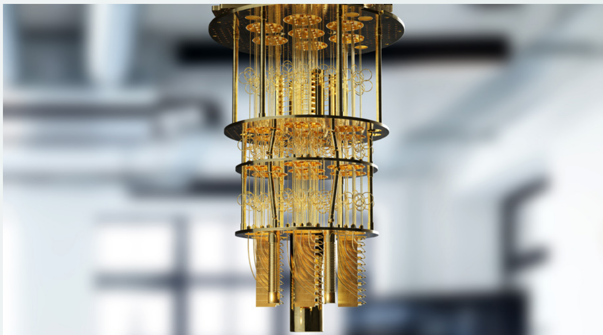
Quantencomputer sind mehrstufig angeordnet und beinhalten ausgeklügelte Kühlmechanismen (Foto: DP – stock.adobe.com)
