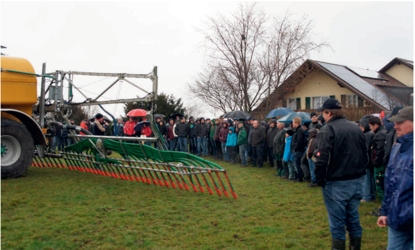
Bild 22.1: Maschinenvorführung Schleppschuhverteiler zur bodennahen Gülleausbringung (Foto: Reinhardt, LWK) Fig. 22.1: Machine demonstration for a trailing shoe spreader to apply slurry close to the ground (Photo: Reinhardt, LWK)
