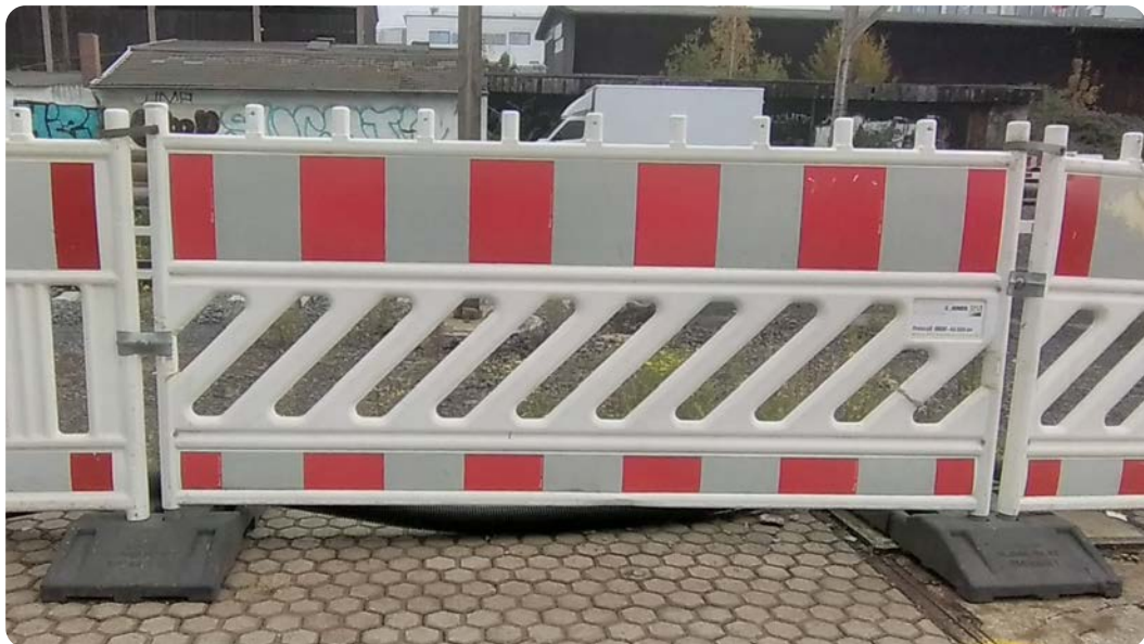
Abb. 20: Absperrschrankengitter zur Absicherung im öffentlichen Verkehrsbereich, Foto: J. Tzschoppe-Komaianda
