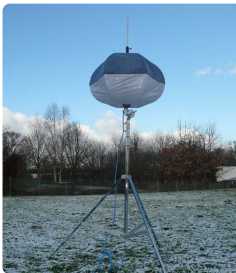
Abb. 25: Leuchtballon für blendfreie tageslichtähnliche Beleuchtung, Foto: A. Krieger
