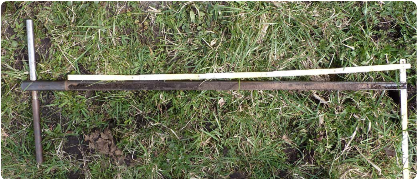
Abb. 35: Pürckhauer (Hohlmeißelbohrer) für Bodenuntersuchung, Foto: SupapleX
