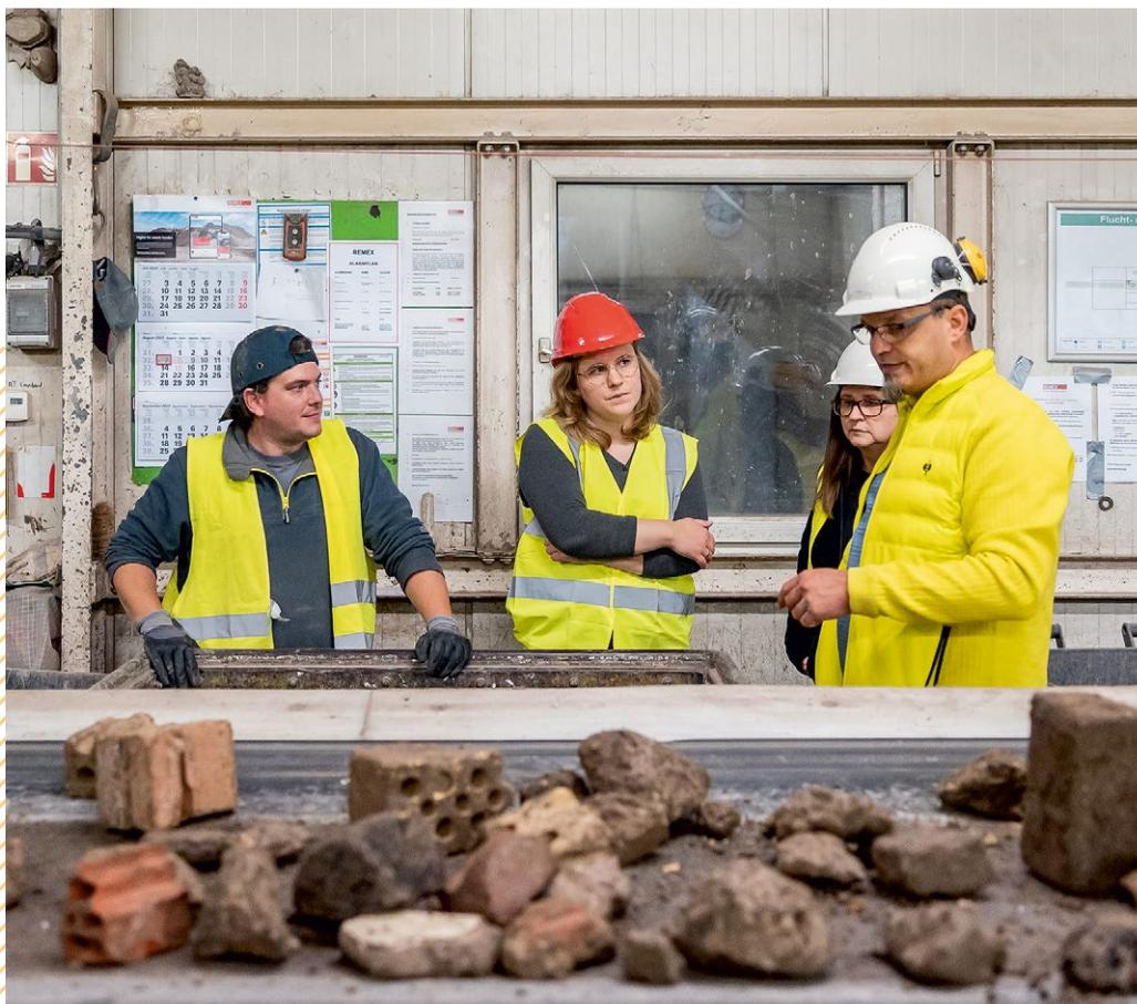
Blick in die Sortierkabine: Hier werden grobe Störstoffe wie Holz oder Drähte manuell entfernt.
