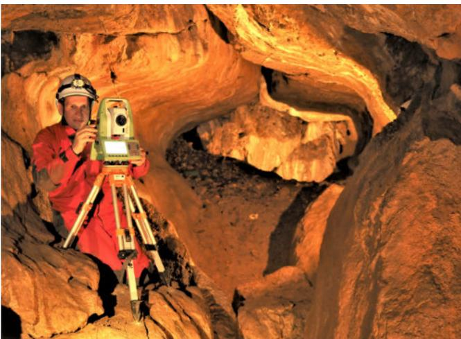
Abb. 1: Björn Wegen (SGS) beim Setzen der Hauptmesspunkte im sog. Zwiebelgang
