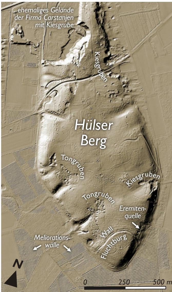
Reliefkarte des Hülser Bergs: deutlich erkennbar sind Ton- und Kiesgruben sowie der Wall der eiszeitlichen Fluchtburg
