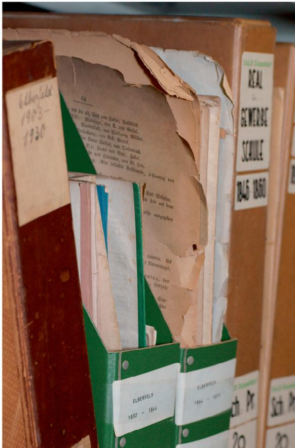
Abb. 4: Holzschliffhaltiges Papier: Falsche Aufbewahrung beschleunigt den Zerstörungsprozess der durch Säureeinwirkung bereits geschwächten Papiere.
