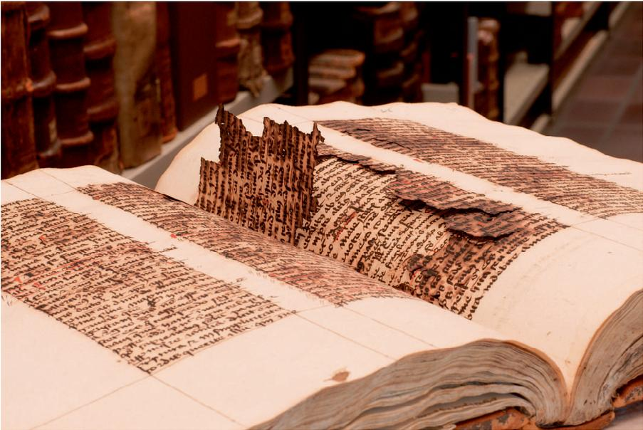
Abb. 5: Tintenfraß verwehrt die Digitalisierung von Handschrift B 20. Sichtbar ist der massive Substanzverlust aufgrund der Einwirkung eisenhaltiger Tinte.
