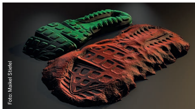
3D-Visualisierung einer mit dem neuen Verfahren gesicherten Schuhideindruckspur (rot) und des Vergleichsschuhs (grün)
