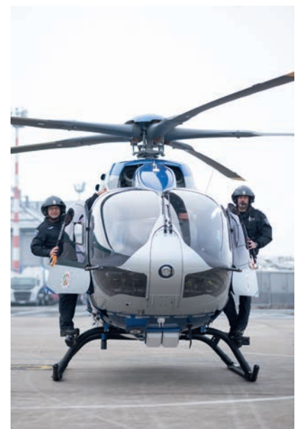
Fünf statt vier Rotoren erleichtern die Einsätze der Fliegerstaffel.
