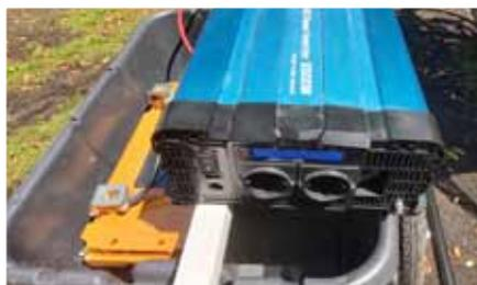
◀ Aus der Batteriespannung kann mit einem Sinus-Wechselrichter 230 Volt in Netzqualität bereitgestellt werden. Die mögliche Leistung für angeschlossene Geräte
