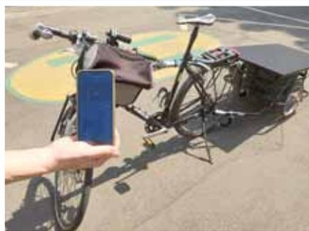
▶ Die Technik mit dem Modul als Deckel kann sicher auf einem Anhänger oder der Ladefläche von einem Lastenrad transportiert werden. Über Bluetooth sind Werte wie die Solarleistung oder die Batterieladung auf dem Smartphone ablesbar.
