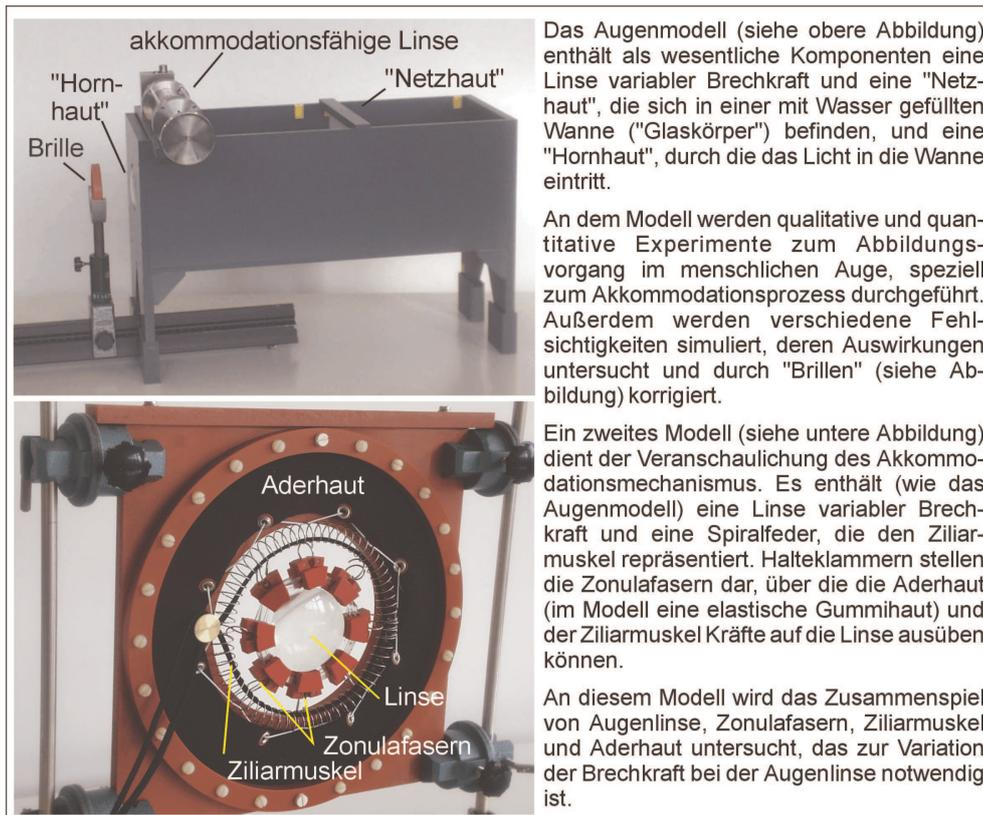
Das Augenmodell (siehe obere Abbildung) enthält als wesentliche Komponenten eine Linse variabler Brechkraft und eine "Netzhaut", die sich in einer mit Wasser gefüllten Wanne ("Glaskörper") befinden, und eine "Hornhaut", durch die das Licht in die Wanne eintritt.
