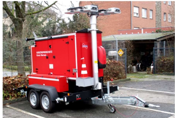
Notstromaggregat mit Lichtmast
