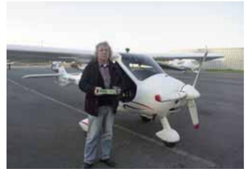
*Für die Messungen hat die FHD ein Ultraleichtflugzeug mit einem optischen Partikelzähler ausgerüstet.*
