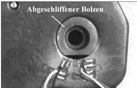
Abb. 8: Dehnungsmessung mit Hilfe von Dehnungsmessstreifen
