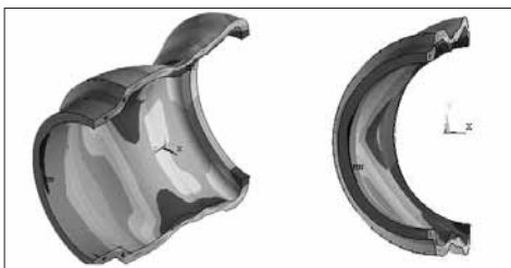
Abb. 9: Finite-Element-Analyse eines plastisch verformten Fittings
