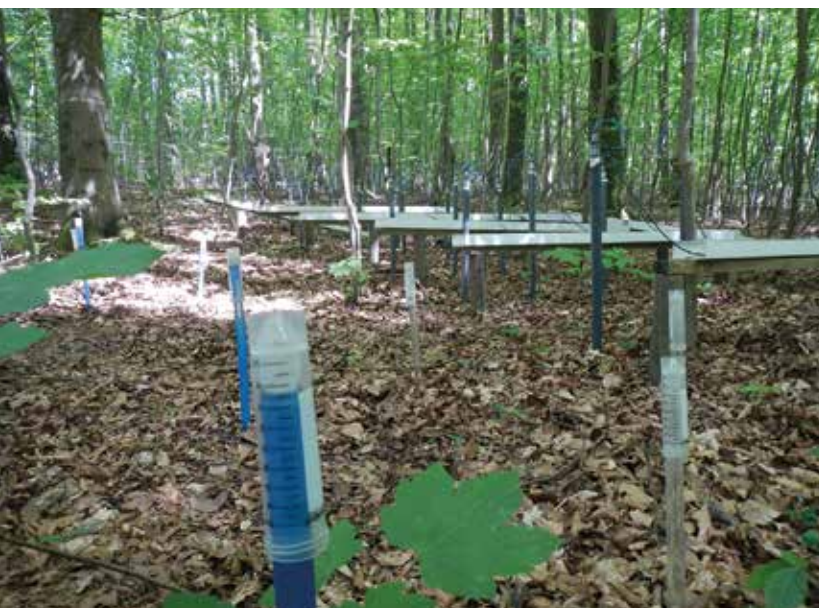
Messung der Bodenwasserspannung mit Tensiometern auf der Level-II-Fläche Schwaney
