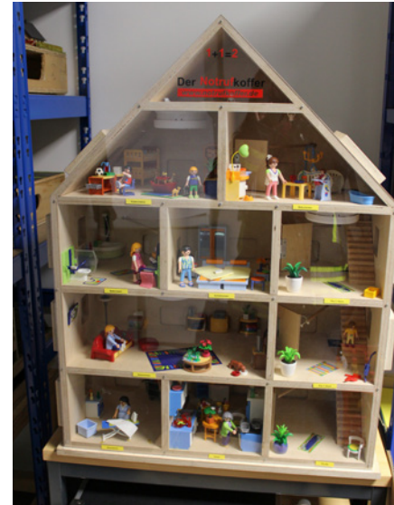
Mit diesem „Rauchhaus“ können Strömungen von Rauch veranschaulicht werden. Alle Türen können von hinten einzeln bedient werden und zeigen, wie sich der Rauch seinen Weg sucht.
