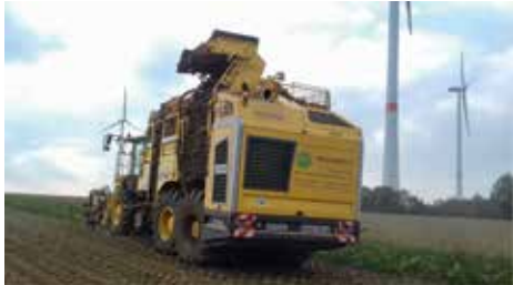
Abb.22 Dreiachsiger Rübenroder mit hydraulischem Fahrwerksystem eingesetzt durch den MR Neuss-Mönchengladbach e.V. bei der Arbeit, Oktober 2018.
