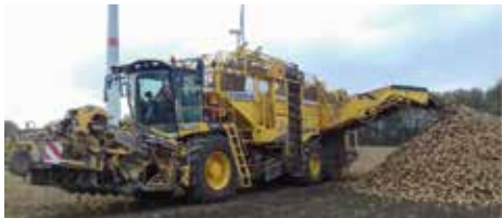
Abb.23 Dreiachsiger Rübenroder mit hydraulischem Fahrwerksystem eingesetzt durch MR Neuss-Mönchengladbach e.V. beim Entladen seines „Bunkers“, Oktober 2018. Das Bunkervolumen beträgt je nach Modell, Tiger oder Panther, bis zu 43 cbm. Diese Rübenroder sind hochtechnisiert und werden je nach Modell von 2 Volvo Motoren mit bis zu 796 PS angetrieben. Bedient werden sie mit einem Touch-Farbterminal.
