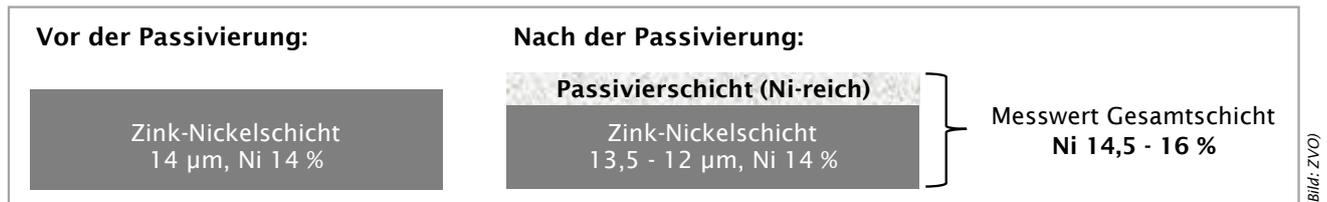
Abb. 7: Abnahme der Schichtdicke und Anstieg des Messwertes der Nickeleinbaurate beim Passivieren
