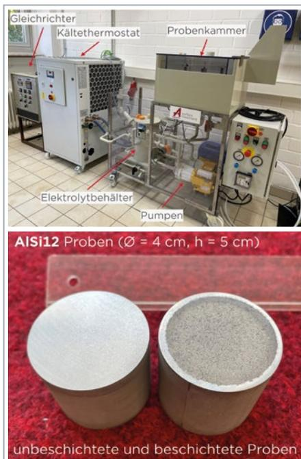
Abb. 2: SELGA-COAT®-Laboranlage und bei der Entwicklung verwendete Proben
