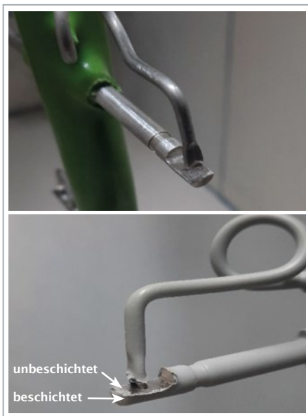
Abb. 7: Kontaktierung links vor und rechts nach Beschichtung
