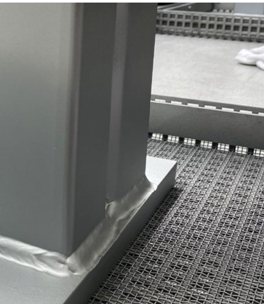
Stahlprofile und -füße für ein selbsttragendes Lagersystem, beschichtet mit RT-Zinklamelle in Spritzapplikation mit besonderem Augenmerk auf den Korrosionsschutz der Schweißnähte
