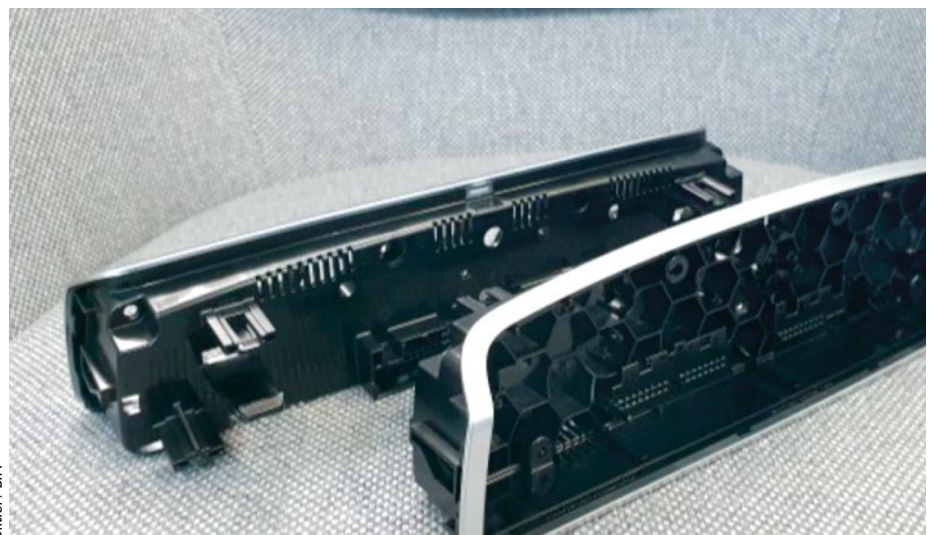
Abb. 1: Musterbauteile aus Polycarbonat mit biobasiertem Phenol als Selektivkomponente
