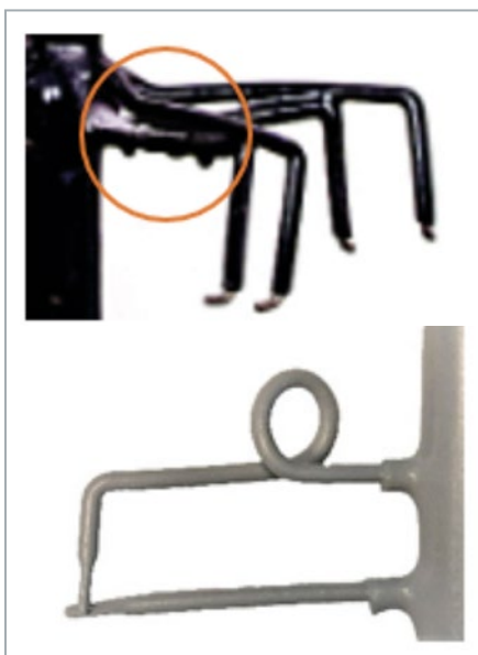
Abb. 8a: Fehlerbilder: Tropfnasen (oben), Rackstar® Premium im Vergleich (unten)
