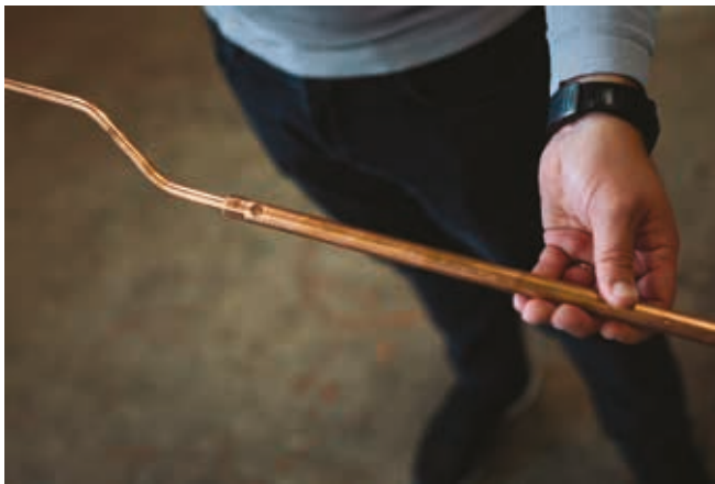
Oben: Hätten Sie es gewusst? So sieht ein Blitzableiter von Nahem aus. Rechts: Kein Gebäude ist zu hoch: Das Unternehmen errichtet Blitzschutzanlagen in schwindelerregender Höhe, wie hier an einem Kirchturm.
