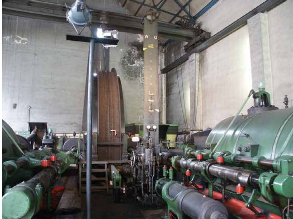
Fördermaschinenhaus mit Dampfmaschine der ehemaligen Zeche Fürst-Leopold. Foto: RIK/Walter
