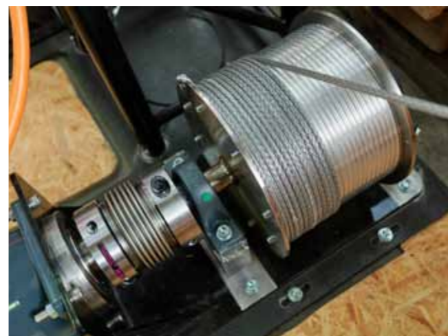
Computergesteuerte Winden spulen die insgesamt 170 Meter Seil auf und ab. Das Seil (Bruchlast: fünf Tonnen) ist gängige Outdoor-Ware.
