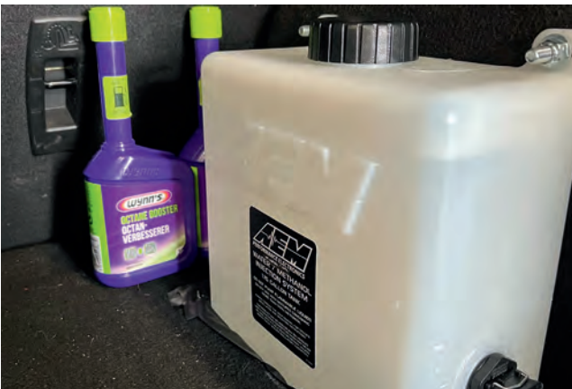
Flüssigkeitsbehälter mit einer Wasser-Methanol-Einspritzung
