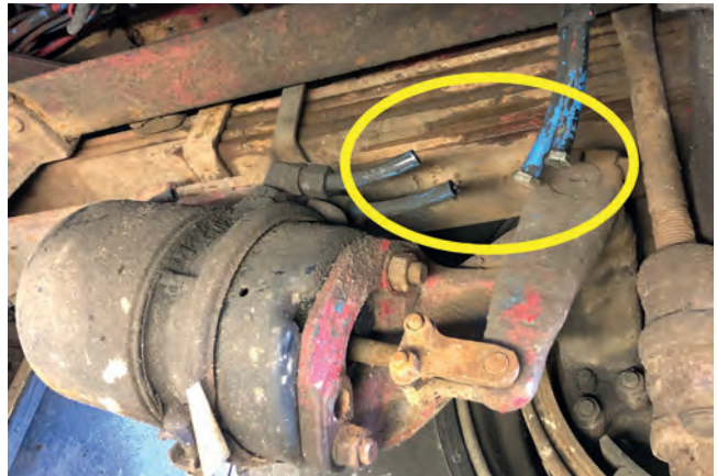
Abgeklemmte Bremsleitungen mittels Schrauben
