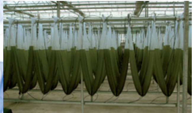
Aufbau der Reaktoren, die aus transparenten Schläuchen bestehen und 600 m 2 Grundfläche des Gewächshauses belegen
