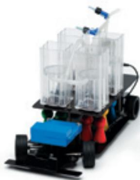
Beispiel für die zu konstruierenden Modellfahrzeuge mit Brennstoffzellenantrieb
