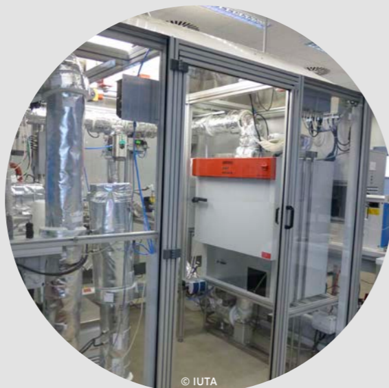
Prüfstand für Filter und Adsorbentien für toxische Gase
