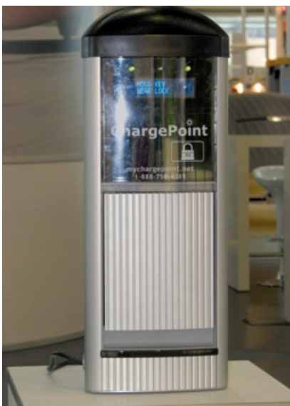
Ladestation mit integriertem Abrechnungssystem von 365 Energy Group (Quelle: Gerd-Uwe Funk, EnergieAgentur.NRW)
