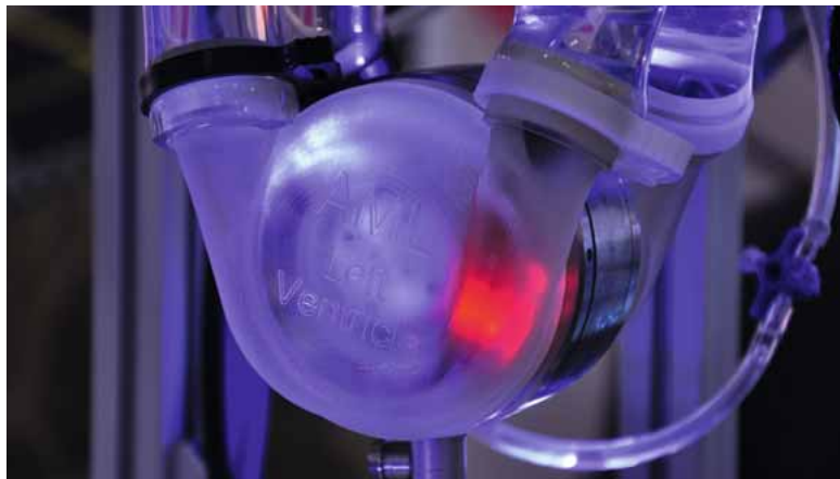
Aachener Kunstherz „ReinHeart“ im dynamischen Prüfstand
