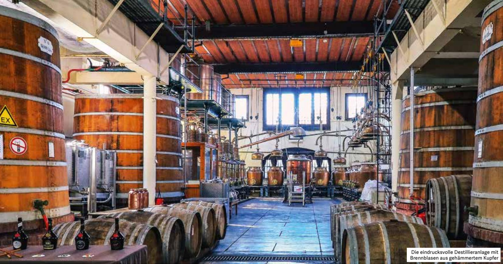
Die eindrucksvolle Destillieranlage mit Brennblasen aus gehämmertem Kupfer
