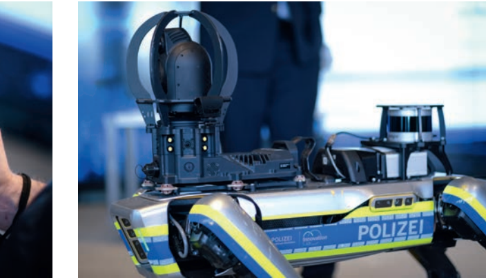
Eine 360-Grad-Kamera und ein Scanner ermöglichen 3D-Bilder auch von Tatorten mit hohem Gefährdungspotenzial.
