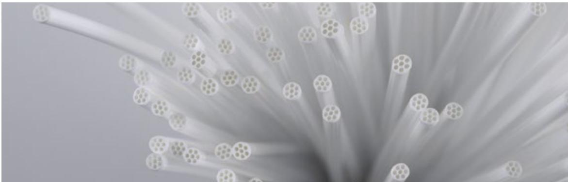
Kapillaren einer Ultrafiltrationsmembran zur Trinkwasseraufbereitung
