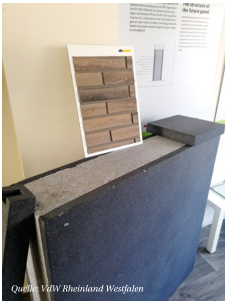
Das Sandwichpanel ist ca. 20 cm dick, die Klinkerattrappen werden aufgeklebt.
