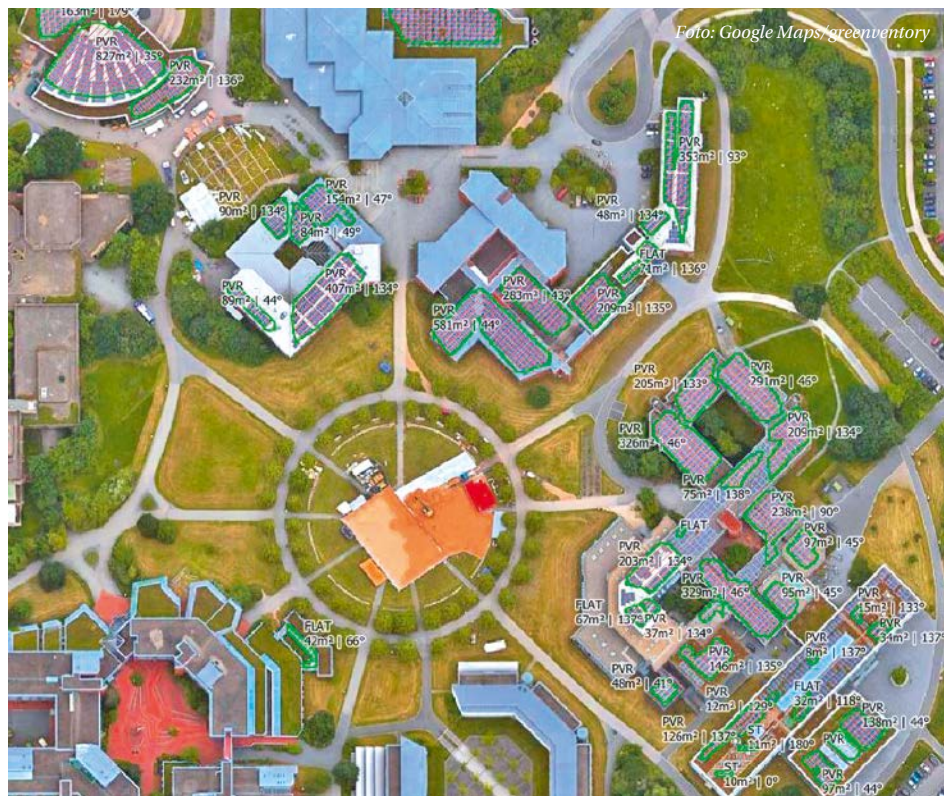
Automatisiertes Erkennen und Inventarisieren von Energiesystemen am Beispiel von Photovoltaikanlagen
