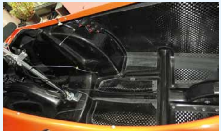
▲ Das lange „Rohr“ rechts oben auf dem Bild ist der Halter für das Tretlager, das daran geklemmt auf verschiedene Fahrerbeinlängen verschoben werden kann, ▼ hier links zu sehen
