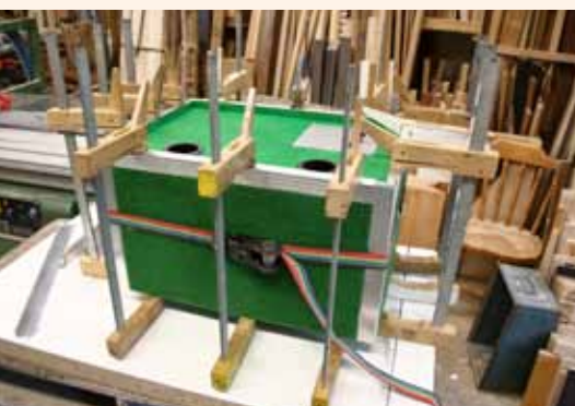
◀ Alle Kanten werden mit Eckprofilen geschützt
