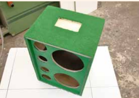
◀ Seiten-Deckel und Boden wurden mit Kunstrasen beklebt
