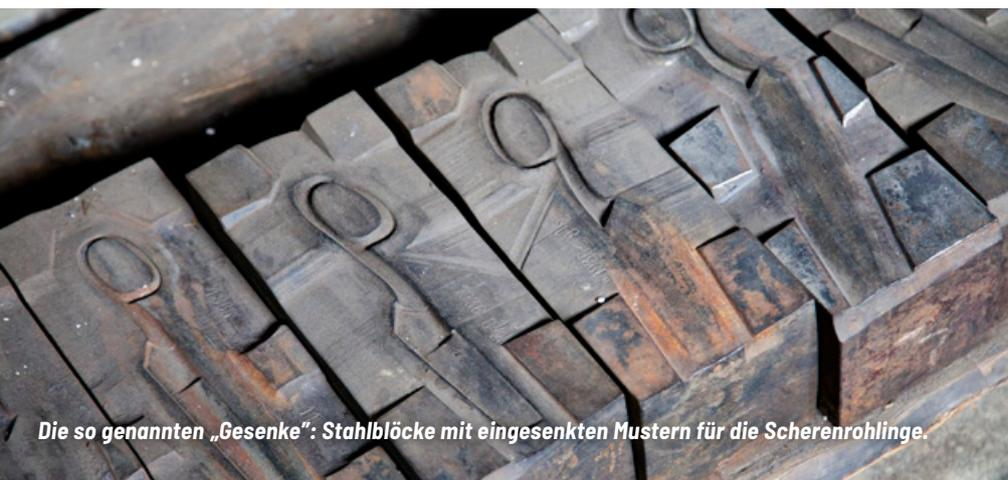
*Die so genannten „Gesenke“: Stahlblöcke mit eingesenkten Mustern für die Scherenrohlinge.*
