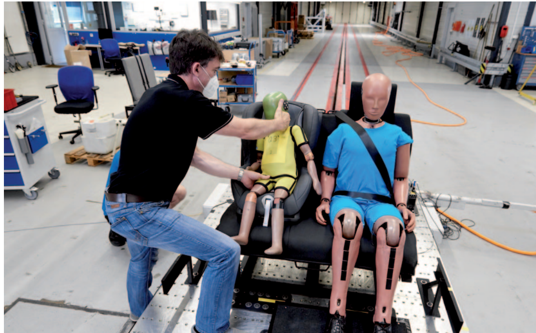
Der ADAC hat in Schlittenversuchen die Sitzbänke in verschiedenen Wohnmobilen getestet.
