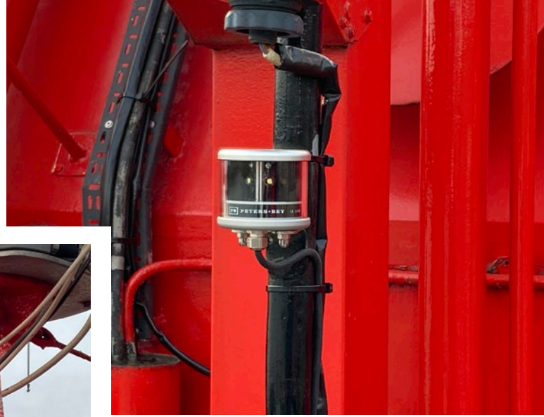
Neue Positionsleuchten – LED-Lampen für eine bessere Sicht
