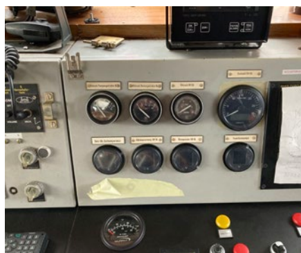
Tausch der alten analogen Anzeige gegen neue digitale Anzeigen im Steuerhaus
