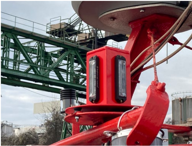
Neue Positionsleuchten – LED-Lampen für eine bessere Sicht
