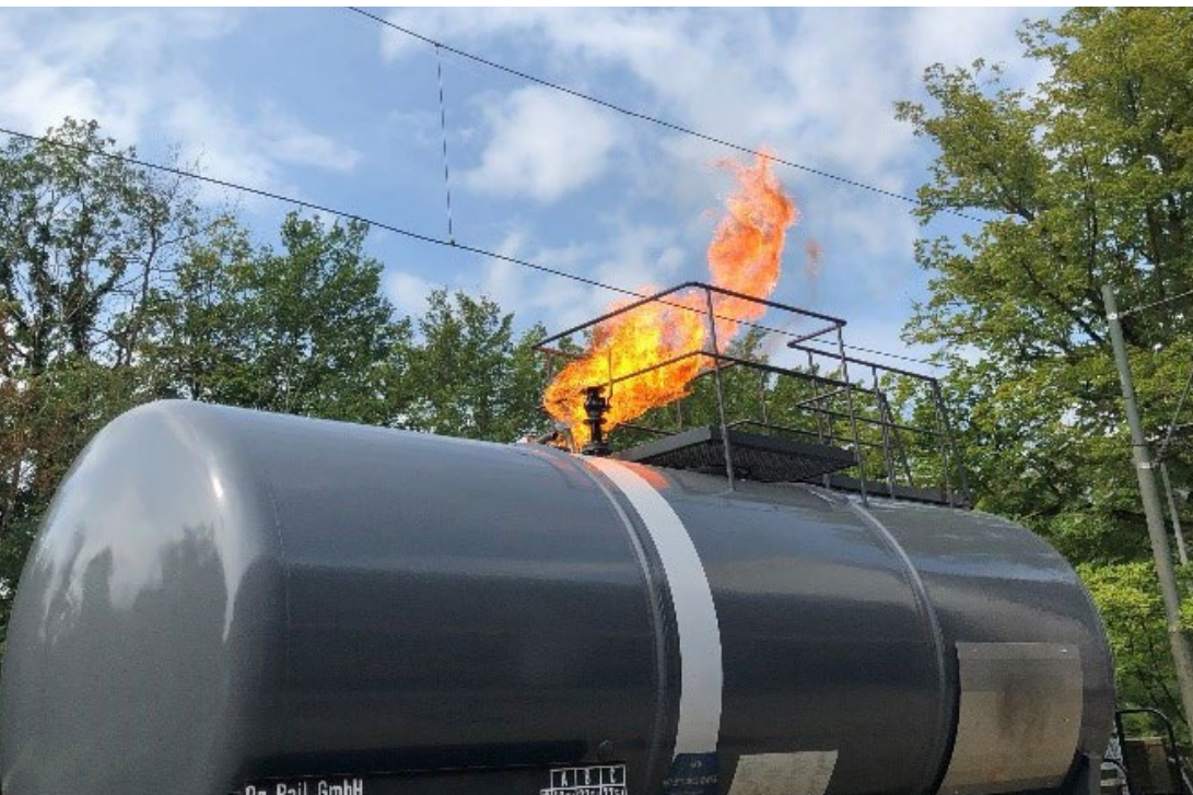
Der Kesselwagen verfügt über zwei Brandsimulationstellen
