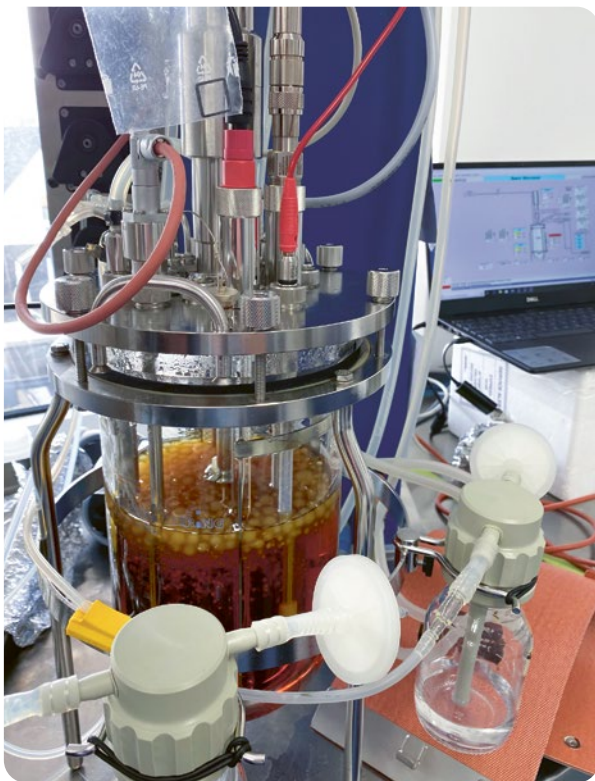
Der Fermentationsprozess zur Kultivierung des Myzels läuft in einem Bioreaktor ab.
