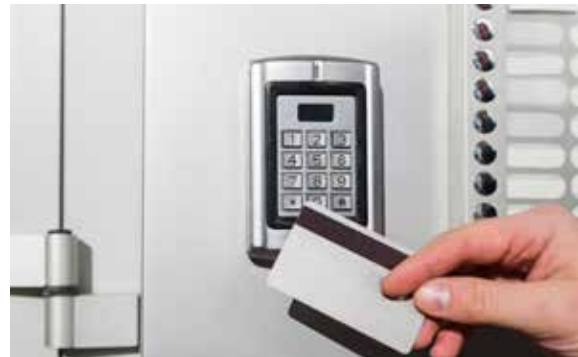
Öffnen der Abstellanlage berührungslos mit Keycard über verschiedene Techniken, z.B. RFID, Foto: zphoto83, Adobe Stock
