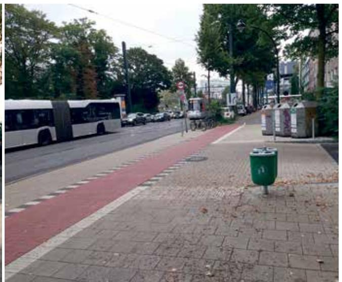
*Engerstraße vorher/nachher: Die Aufpflasterung reduziert die Geschwindigkeiten des querenden Kfz-Verkehrs und sorgt so für mehr Sicherheit und Komfort für den Rad- und Fußverkehr entlang der Grafenberger Allee. Foto: Amt für Verkehrsmanagement*
