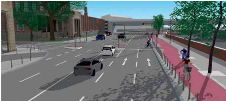
Durch den neu aufgeteilten Straßenraum wird zum Rheinufer hin mehr Platz für den Seitenraum geschaffen, in dem nun der Rad- und Fußverkehr separiert wird und ein Zweirichtungsradweg in rotem Asphalt Platz findet. © Grafik: Amt für Verkehrsmanagement
