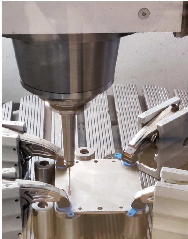
Abb. 1: Fräsung der Form in vernickelter Kupferbodenplatte
