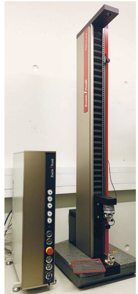
Abb. 5: Zugtest-Maschine Zwick von Roel mit rot gekennzeichnete Bodenplatte
