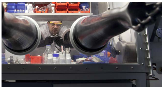
Batterieforschung an der Universität Münster. Die im Batterieforschungszentrum MEET entstehenden Testzellen werden unter Ausschluss von Sauerstoff und Feuchtigkeit in der Glovebox von einem Doktoranden zusammengebaut. Foto: IMAGO / Phototek
