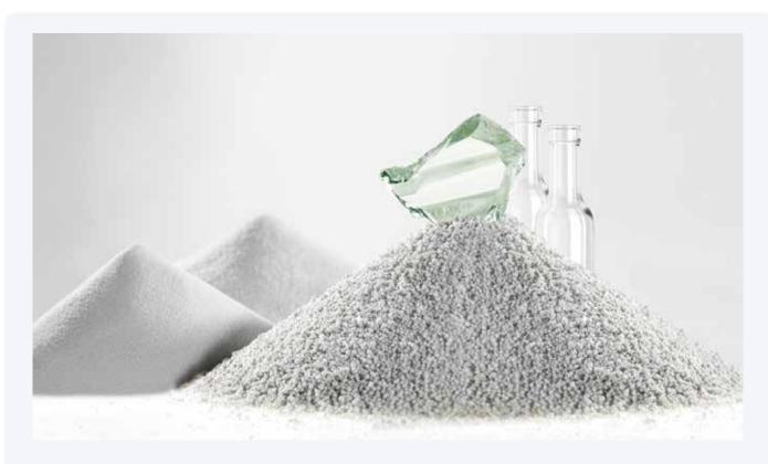
Glas besteht fast ausschließlich aus den natürlichen Rohstoffen Kalk, Sand und Soda – und zu einem großen Teil aus recyceltem Glas.
